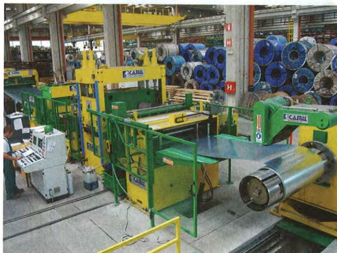
Ligne de refendage avec planeuses 1600 x 3 mm Poids bobine 15 tonnes, vitesse 50 m/min
