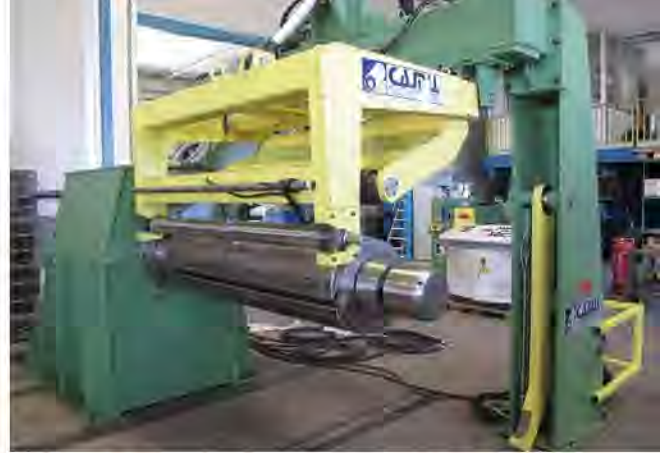
Mit dieser Wicklereinheit werden die mit dem Rundmesser geschnittenen Streifen kompakt in Bänder aufgewickelt.
