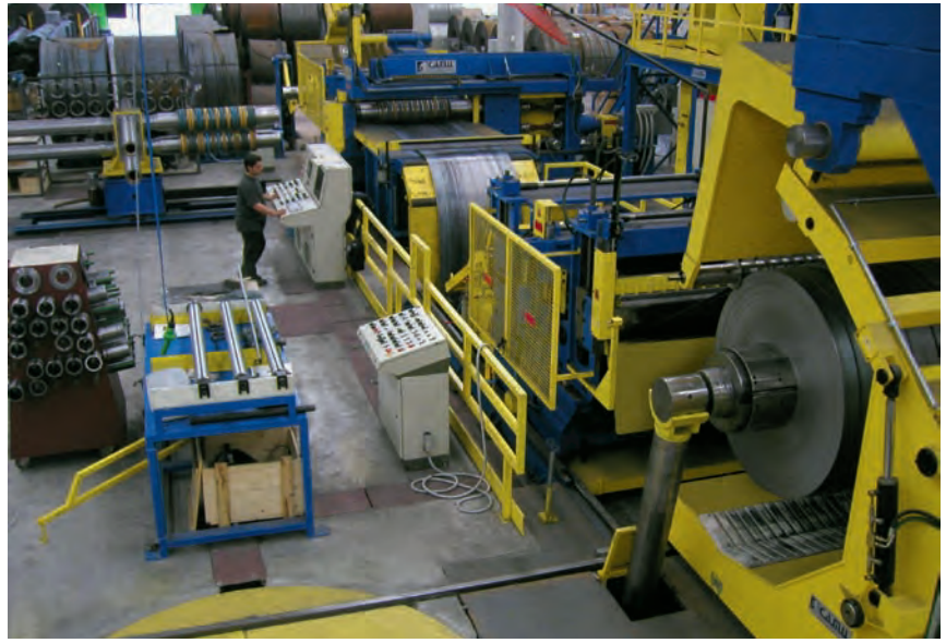
Linia slitter od strony nawijaka
