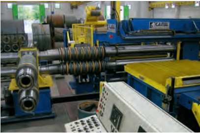
Karuzela wymiany ostrzy z 4 ramionami
